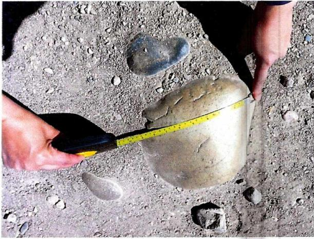
Fotografía N° 13: Reperfilado con material con sobre tamaño.
